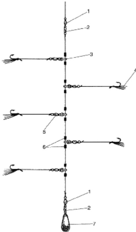
Рис. 317. Самодур на мерланга: 1 – вертлюжок; 2 – карабин; 3 – шайба; 4 – оперение или кембрик; 5 – вертлюжок на поводке; 6 – стопор; 7 – грузило
